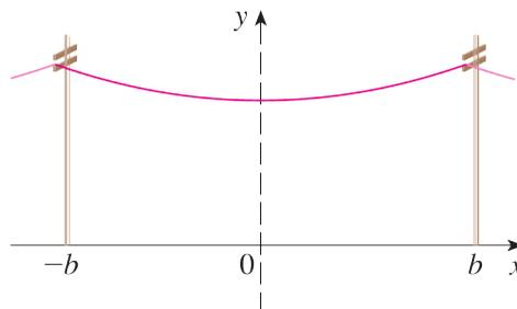
Figura 2: Cabo telefônico suspenso em forma de catenária
