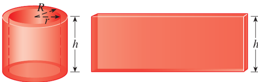
Figura 1: Caixa d'água formada por casca cilíndrica e diagrama da casca “desenrolada”
